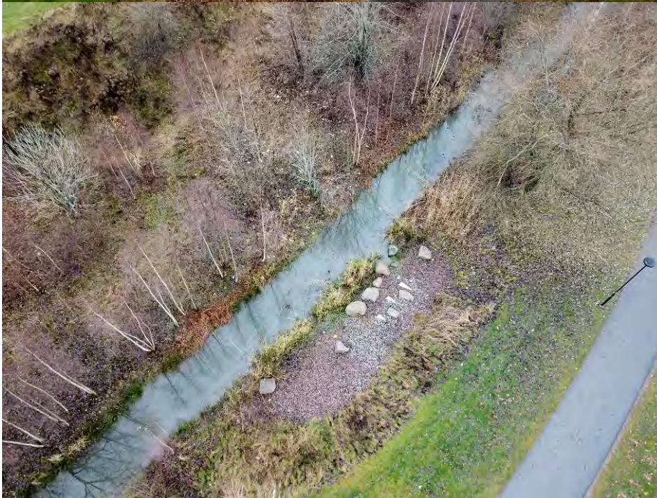
Figur 80. Åtgärder för att låta vattnet ta plats vid högflöden i Örebro kommun. Övre bild: en parallell sidofåra har skapat för att ta emot vatten vid högflöden. Nedre bild: Avfasade stränder som hårdgjorts för att ta emot och bromsa vatten vid högflöden. Foto: Erik Degerman.
