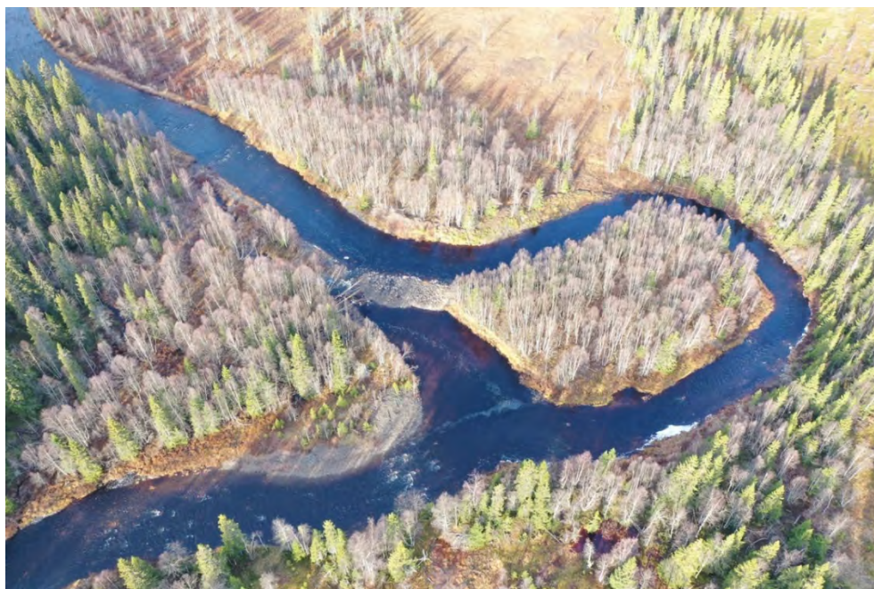
Figur 145. En rätning gjord för flottningen genom att skära igenom en meanderbåge vid Storudden i Laxbäcken, Vilhelmina, har åtgärdats genom att lägga igen passagen med sten och block. Eftersom vattendraget rätats på flera ställen är vattenflödet vid vårflod så starkt att man inte vågat lägga igen helt, utan tillåter ett visst flöde igenom. Foto: Micke Strömberg, Model forest.
