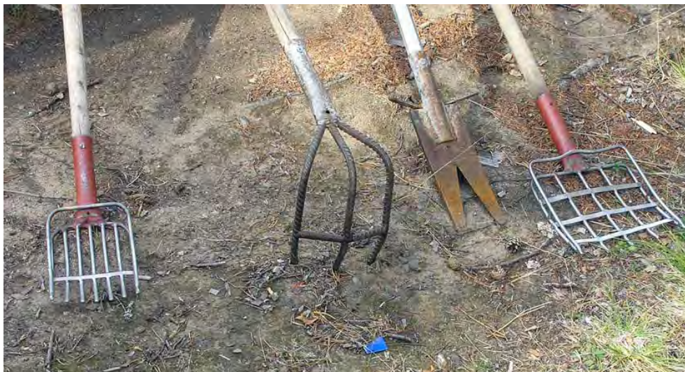
Figur 169. Fyra specialutvecklade redskap för Hartijoki-metoden vid etablering av lekbottnar för öring. Med de två mittersta redskapen (kratta respektive spett) luckras botten upp och större sten och block flyttas. Det högra redskapet (sikten) används sedan för att ta bort mindre sten som anses för stora (>5 cm) som leksubstrat. Det vänstra redskapet (skyffel) används för att sålla ut och flytta lämpligt lekmaterial. Detta flyttas till den nya lekbotten. Redskapen kan man tillverka själv eller beställa på hemsidan för Nilivaara sportfiskeklubb. Foto: Erik Degerman.
