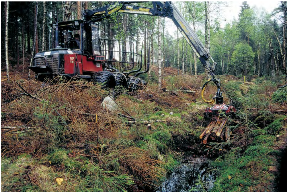
Figur 65. Igenläggning av dike med hjälp av skotare. Man har passat på att avverka gran i kantzonen och använder den som fyllnadsmaterial. Foto: Lennart Henrikson.
