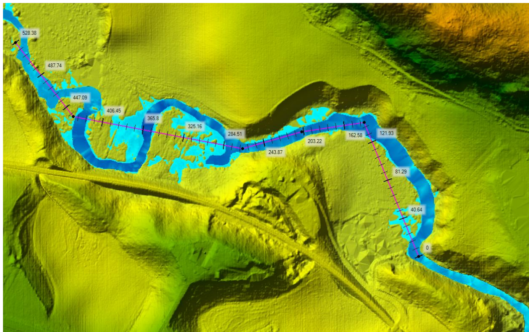
Figur 140. Vid beräkning av sinositet delas fårans längd med dalgångens längd. På bilden visas det hur dalgångens längd mäts. Dalgångens längd mäts alltså mitt i dalgången och inte fågelvägen. I detta exempel var dalgångens längd 528 meter och fårans längd 680 meter vilket ger en sinositet på 1.29 ( 680/528=1.29 ).
