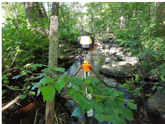
Figur 134. Exempel på en bestämmande sektion som utgjorts av sten och block som rensats vilket medfört sänkt basnivå. Här mäts ett antal tvärsnitt i fält inför en modellering av vilka vattennivåer som kommer erhållas efter åtgärd. Foto: Peter Gustafsson, Streams & Lakes Consulting AB.
