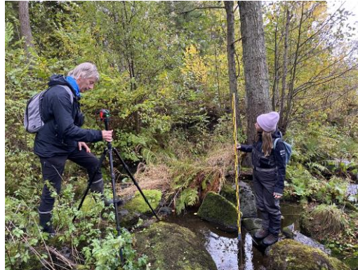
Figur 11. Länsstyrelsen i Östergötland ute i en B-sträcka och både läser av och mäter in ett vattendrags morfologi. Foto: Länsstyrelsen Östergötland.
