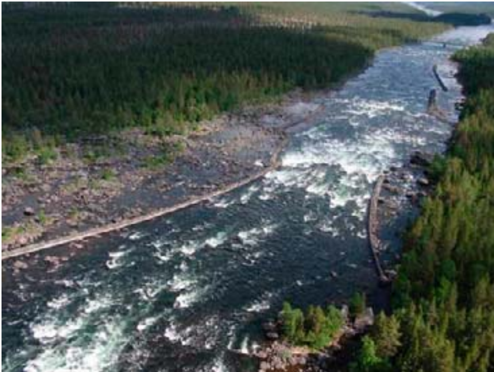
Flygbild av Björnideforsen i Piteälven. Älven har trängts ihop med stenkistor och rensats för att underlätta flottning. Bilden är tagen i nedströmsriktning. Foto: Niclas Hjerdt.
