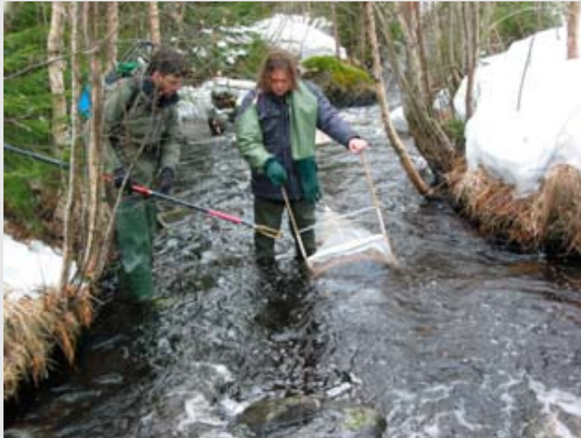
Elfiske efter bottendjur. Mannen till vänster håller i anoden medan mannen till höger sköter drifthåven. Metoden bygger på att djuren paralyseras av strömmen, lossnar och driver iväg varefter de kan fångas. Foto: Per-Ola Hoffsten.
