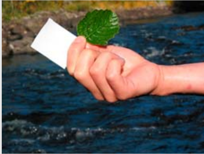
Konstgjort löv och allöv (gråal). Konstgjorda löv används för att studera lövs transport i ett vattendrag. Foto: Fabio Lepori.
