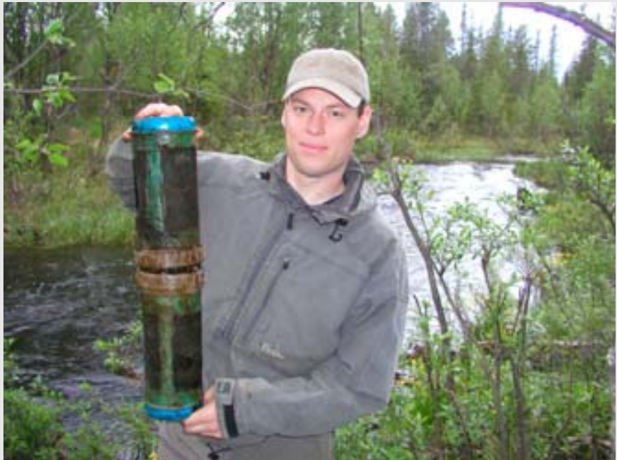
Nätcylander som används för att studera ägg och yngelöverlevnaden hos till exempel öring. Metoden bygger på att ägg och yngel hålls fånga i cylindern samtidigt som de upplever rådande miljöförhållanden (förutom rovdjur). Foto: Mikael Nilsson.
